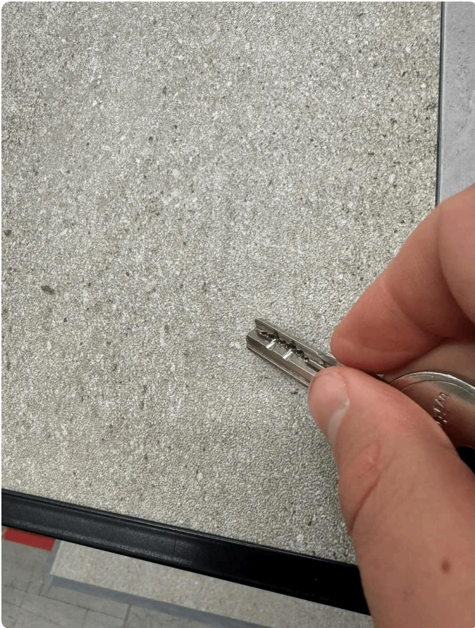
Dumawall beige mat : Test de la clé réussi car aucune marque
